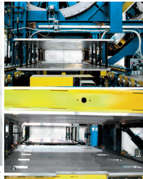
Autom. Formenträgerwechsel bei höherer Formenwechselfrequenz sinnvoll. Autom. Mould change for very frequent mould changes recommended.
