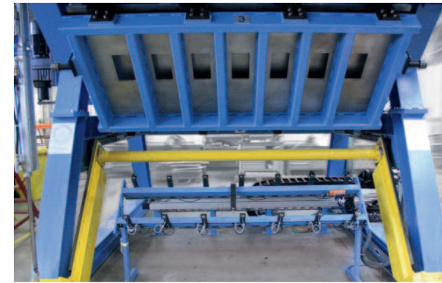
Schaumeintrag in die geschlossene Form durch Eintragsautomat an der Stirnseite des Formenträgers.
