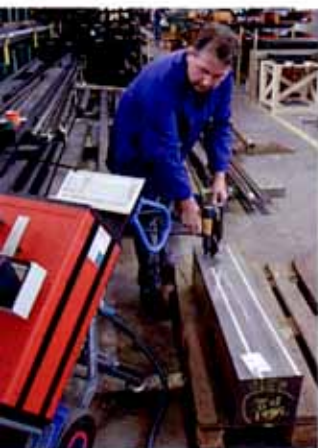
Mit dem Spektralanalysegerät werden die Werkzeugstähle geprüft.
