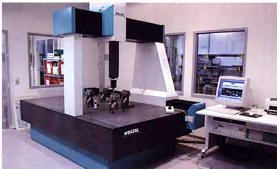
Exakte Vermessung der Mischkopfehäuse mit der 3-Koordinaten-Messmaschine.
