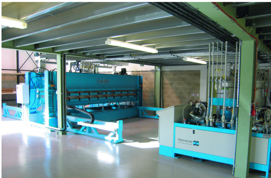
Effektive Produktion von PUR-Sandwichelementen - Hennecke Dosiertechnik und diskontinuierliche Pressen von AutoRIM
