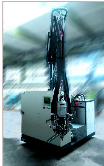
ElastoLine, das neue Gesamtkonzept zur Verarbeitung von Elastomer-Gießsystemen
