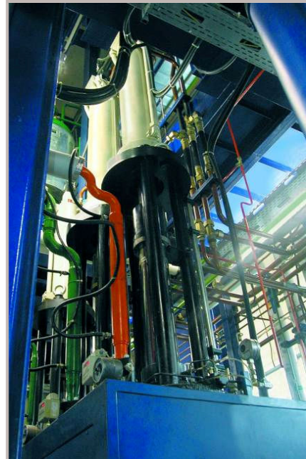
Der Rimdomat arbeitet mit so genannten Tauchkolben-Dosierzylindern, die darauf abgestimmt sind, die benötigten Schussgewichte in einem einzigen Dosierhub höchst präzise zu erzielen
