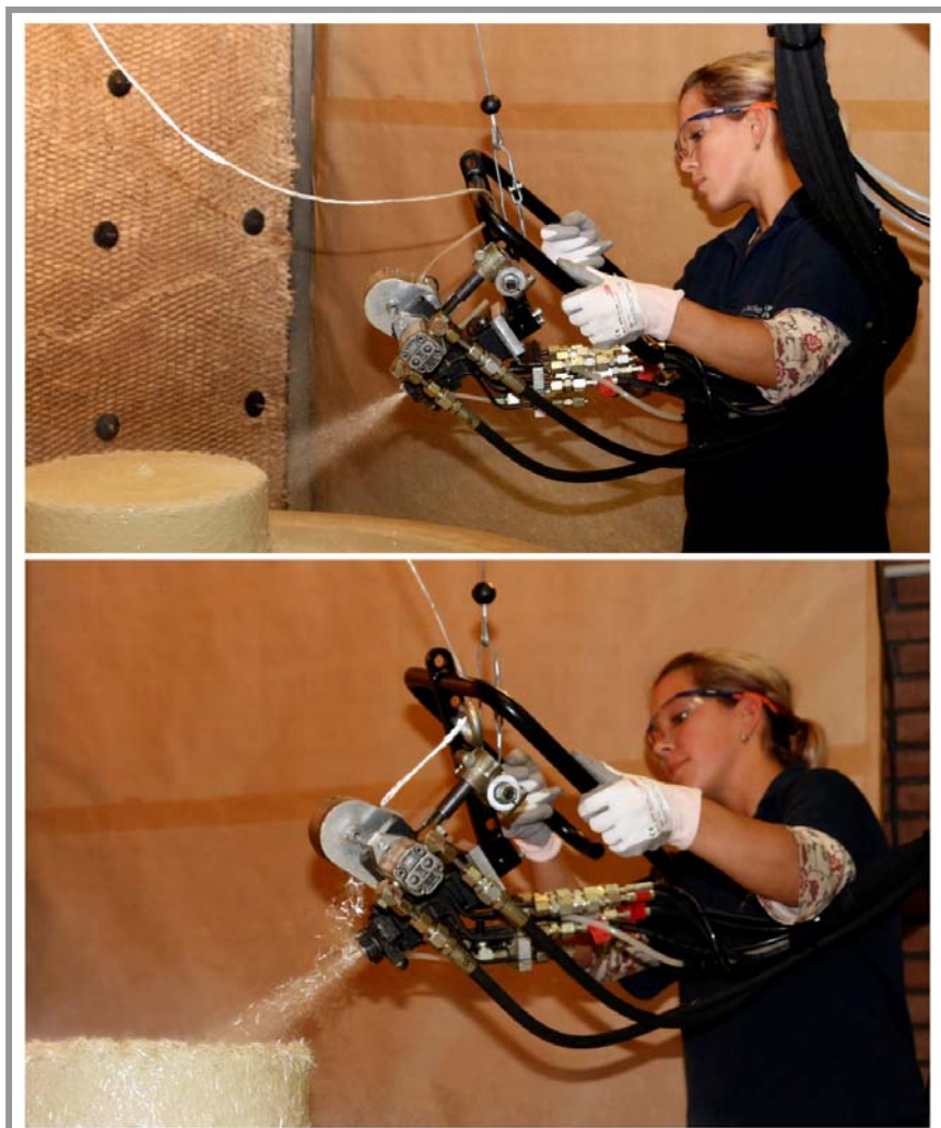
Handsprühvorgang oben ohne und unten mit Glasfaserdosierung
