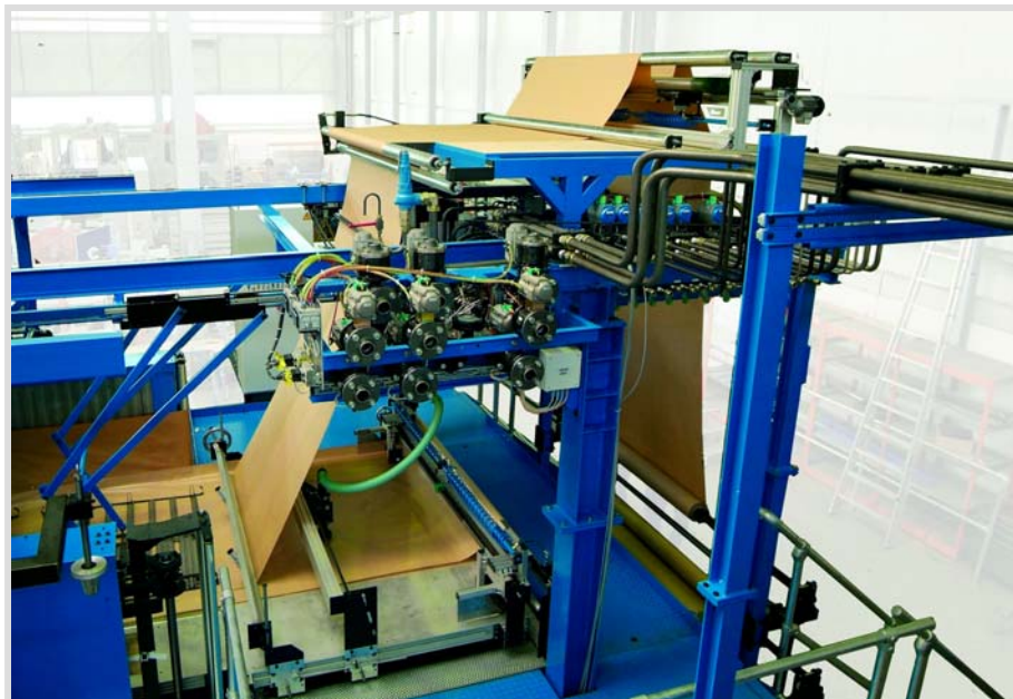
Mischereinheit mit Gemischaustrag Foto: Hennecke GmbH
