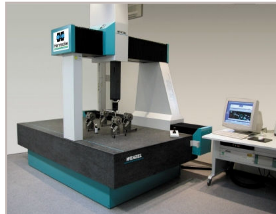
Exakte Vermessung der Mischkopfgehäuse mit der 3-Koordinaten-Messmaschine
