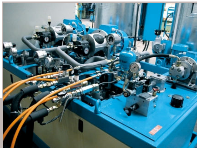
Hochdruck-Reaktionsgießmaschine vom Typ HK 55, angepasst an das neue Schaumstoffsystem
