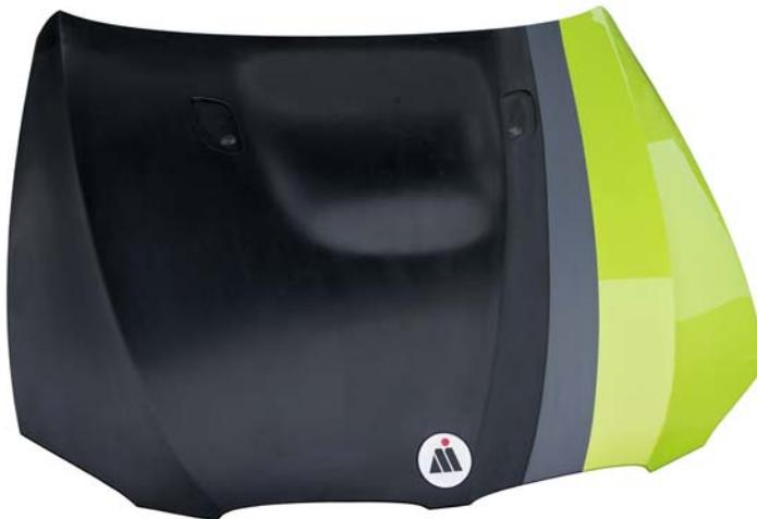
Neue Motorhaube mit Wabenkern in Honeycomb-Struktur und Class-A-Oberfläche
