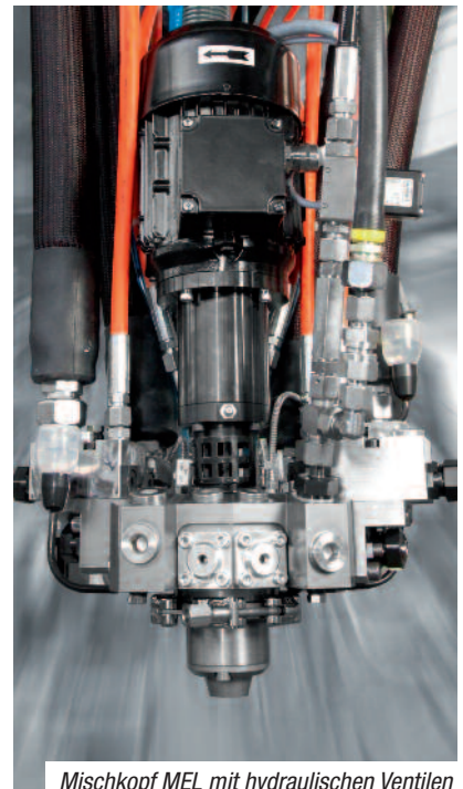
Mischkopf MEL mit hydraulischen Ventilen
