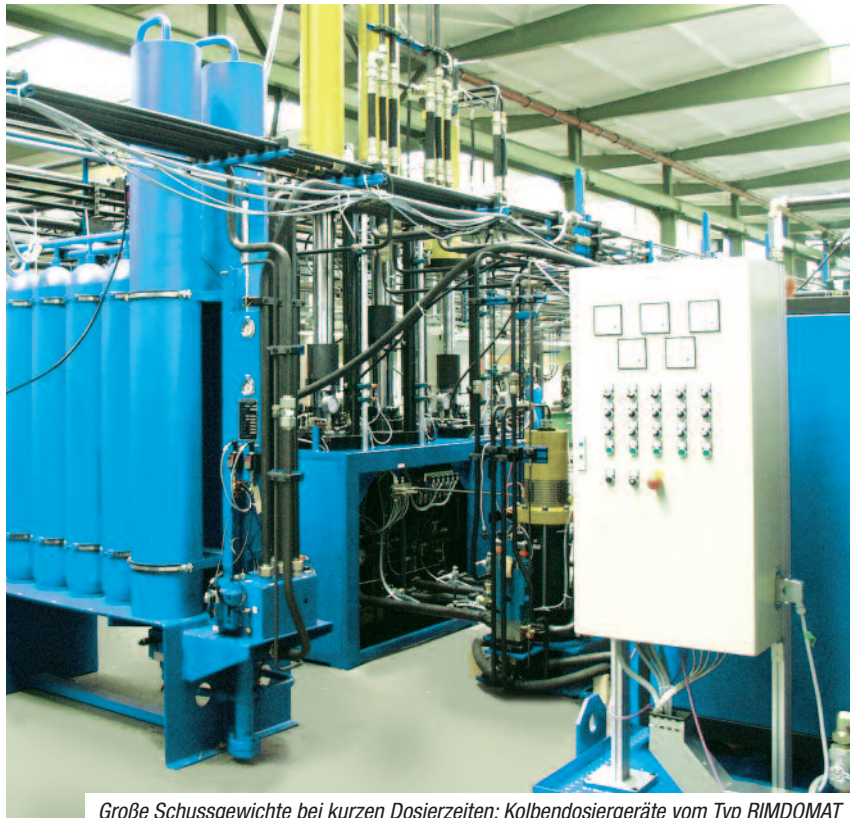
Große Schussgewichte bei kurzen Dosierzeiten: Kolbendosiergeräte vom Typ RIMDOMAT
