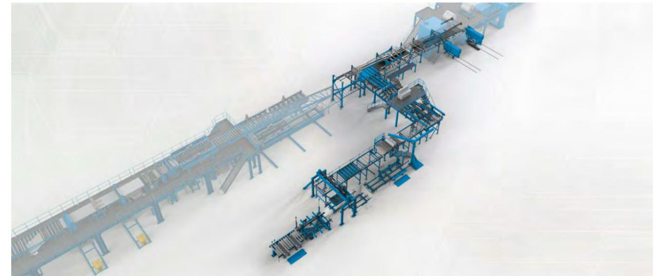
Für die Zwischenlagerung und Kühlung der Paneele vorgesehen. Anschließend werden die Elemente aufgestapelt und mit Schutzfolien und Zwischenschichten versehen.
