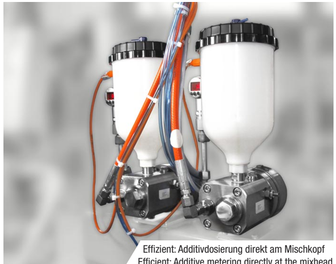
Mischkopf MEL-8C mit hydraulischen Ventilen MEL-8C mixhead with hydraulic valves
