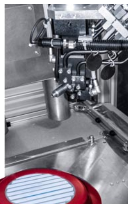
Automatisierter Polyurea-Sprühaufrag zur Beschichtung der Filter-Stirnseite
