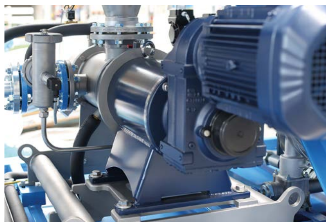
Kernkomponente für die homogene Vermischung: Schneckenförderer mit nachgelagertem Stiftmischer.
