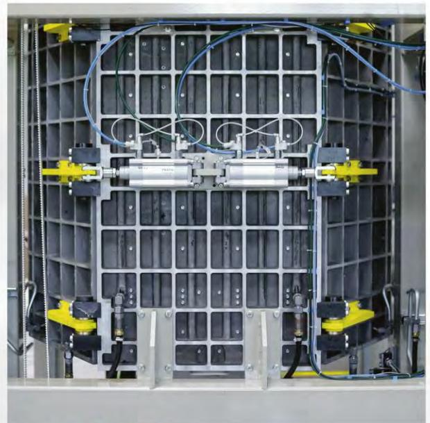
*Sicher und zuverlässig: Schließen und Öffnen mittels pneumatischer Zylinder*
