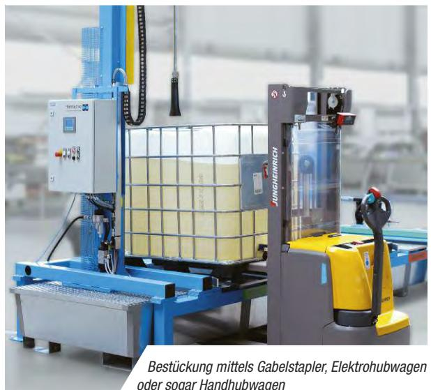
*Bestückung mittels Gabelstapler, Elektrohubwagen oder sogar Handhubwagen*
