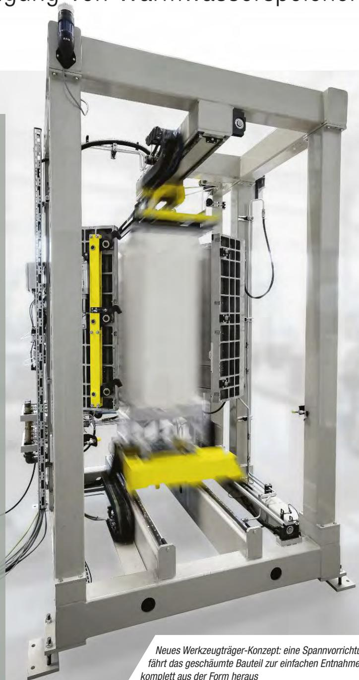
*Neues Werkzeugträger-Konzept: eine Spannvorrichtung fährt das geschäumte Bauteil zur einfachen Entnahme komplett aus der Form heraus*
