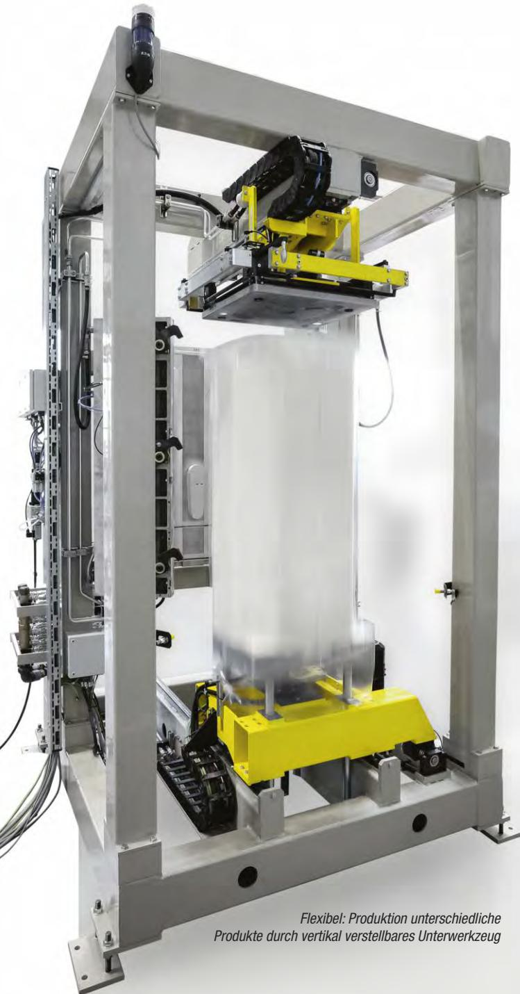
*Flexibel: Produktion unterschiedliche Produkte durch vertikal verstellbares Unterwerkzeug*
