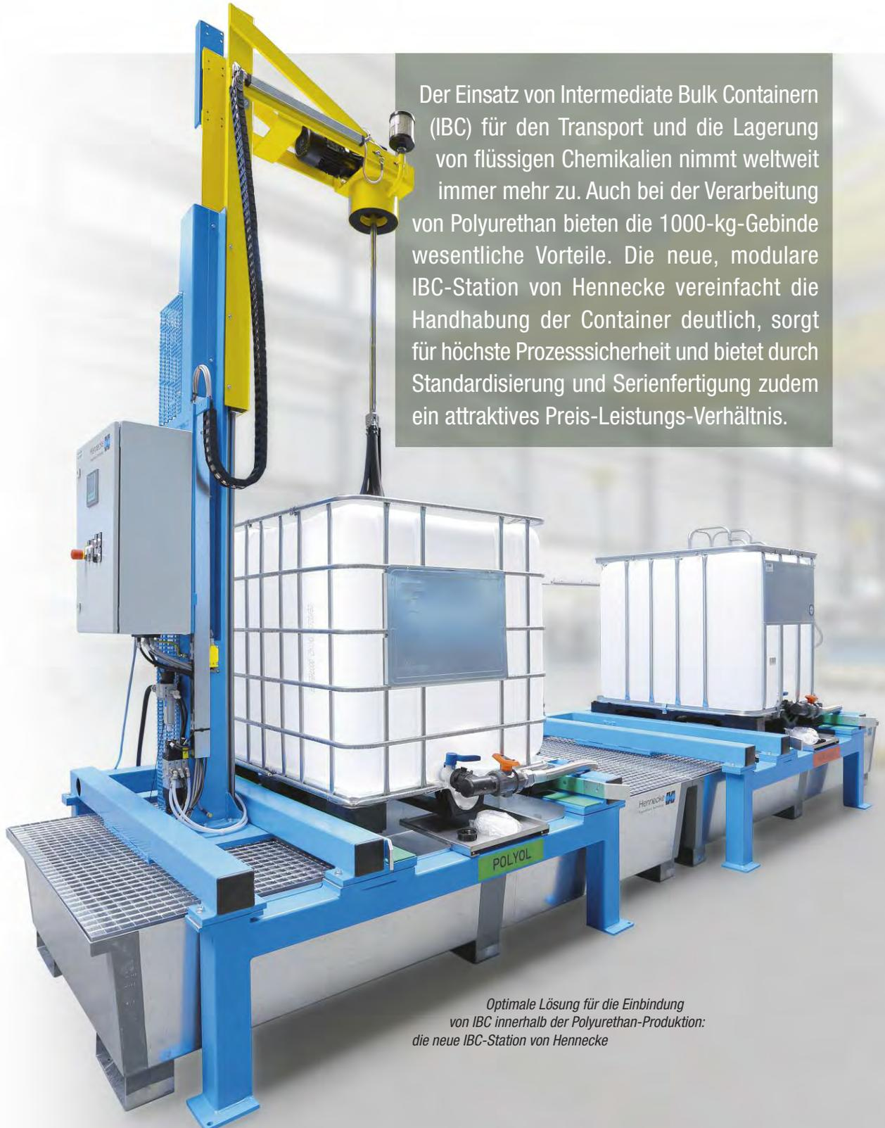
Der Einsatz von Intermediate Bulk Containern (IBC) für den Transport und die Lagerung von flüssigen Chemikalien nimmt weltweit immer mehr zu. Auch bei der Verarbeitung von Polyurethan bieten die 1000-kg-Gebinde wesentliche Vorteile. Die neue, modulare IBC-Station von Hennecke vereinfacht die Handhabung der Container deutlich, sorgt für höchste Prozesssicherheit und bietet durch Standardisierung und Serienfertigung zudem ein attraktives Preis-Leistungs-Verhältnis.
