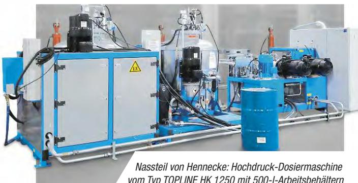
*Nassteil von Hennecke: Hochdruck-Dosiermaschine vom Typ TOPLINE HK 1250 mit 500-l-Arbeitsbehältern*
