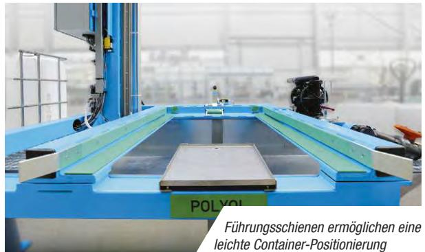
*Führungsschienen ermöglichen eine leichte Container-Positionierung*
