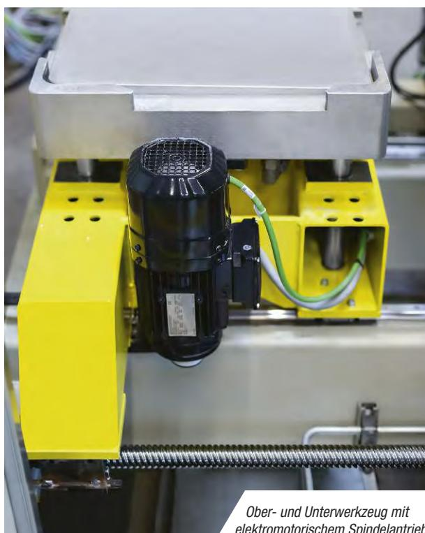
*Ober- und Unterwerkzeug mit elektromotorischem Spindeltrieb*
