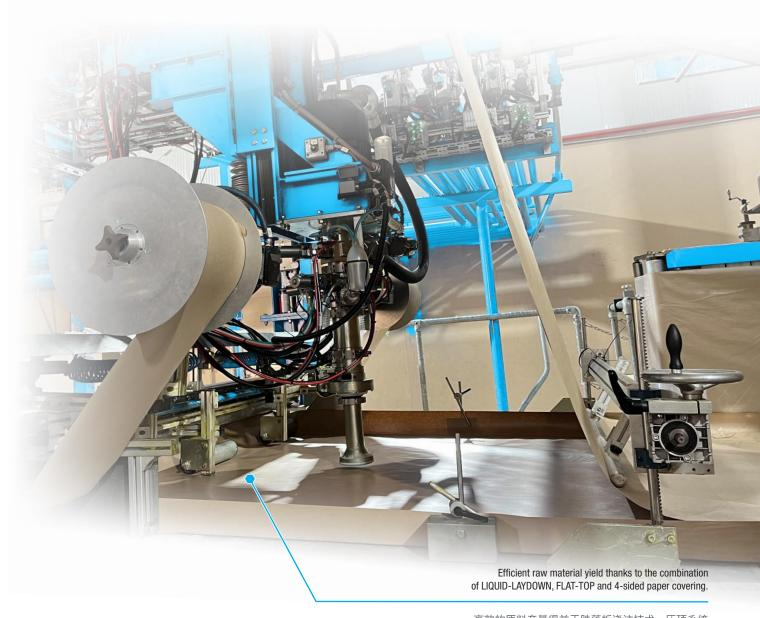
高效的原料产量得益于跌落板浇注技术、压顶系统 和四面纸覆盖的组合。
