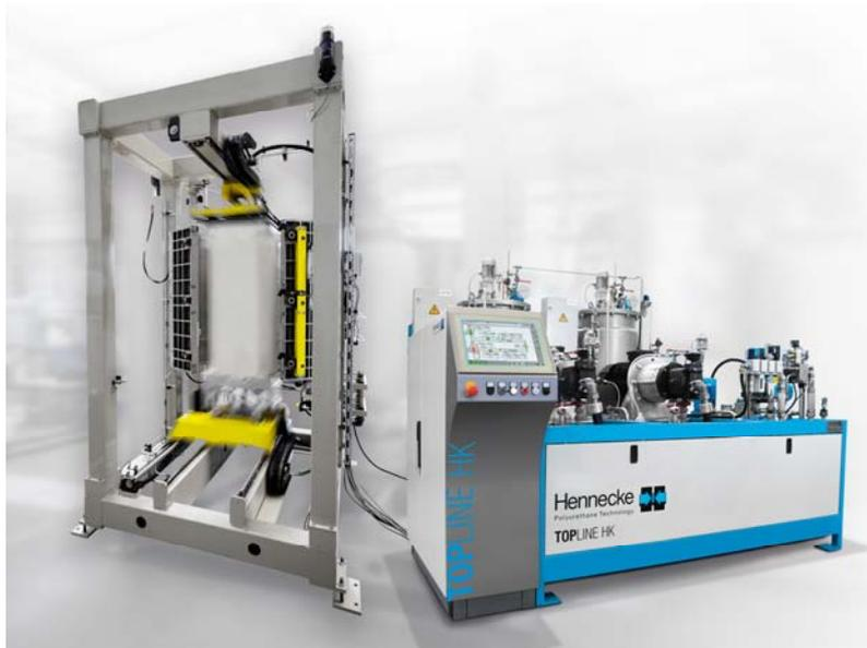
Neues Werkzeugträger-Konzept: Eine Spannvorrichtung fährt das geschäumte Bauteil zur einfachen Entnahme komplett aus der Form heraus. Die Dosieraufgabe übernimmt im Anlagenverbund eine TOPLINE Hochdruck-Dosiermaschine in der Baugröße 650/650.
