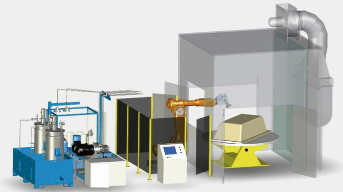
Durch den robotergeführten Einsatz verfügt bereits die Fertigungszelle vom Typ BASIC über einen hohen Qualitätsstandard. Die Anlagentaktzeit richtet sich bei dieser Variante nach der Dauer des Sprühauftrages beim jeweiligen Produkt. Bereits die Fertigungszelle BASIC lässt sich modular erweitern.
