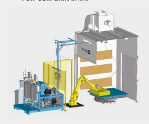
ロボット制御を採用することにより、型式 BASIC の製造セルは、非常に高い品質水準を保つことができています。当バージョンのプラントのサイクル時間は、各製品のスプレー時間により異なります。型式 BASIC の製造セルは、少および中量生産、新製品やジオミトリーの開発に適しています。
