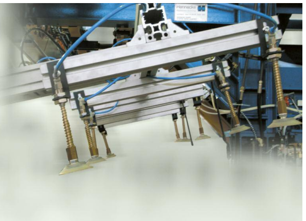
Automatisches Türentnahmegerät entlang der X-Achse Automatic door removal along the x-axis
