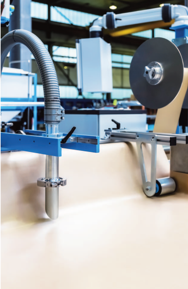
Innovative und kompakte Papierführung mit MIXGUIDE-Rücklaufsperr Innovative and compact paper guiding system with MIXGUIDE deflection plate
