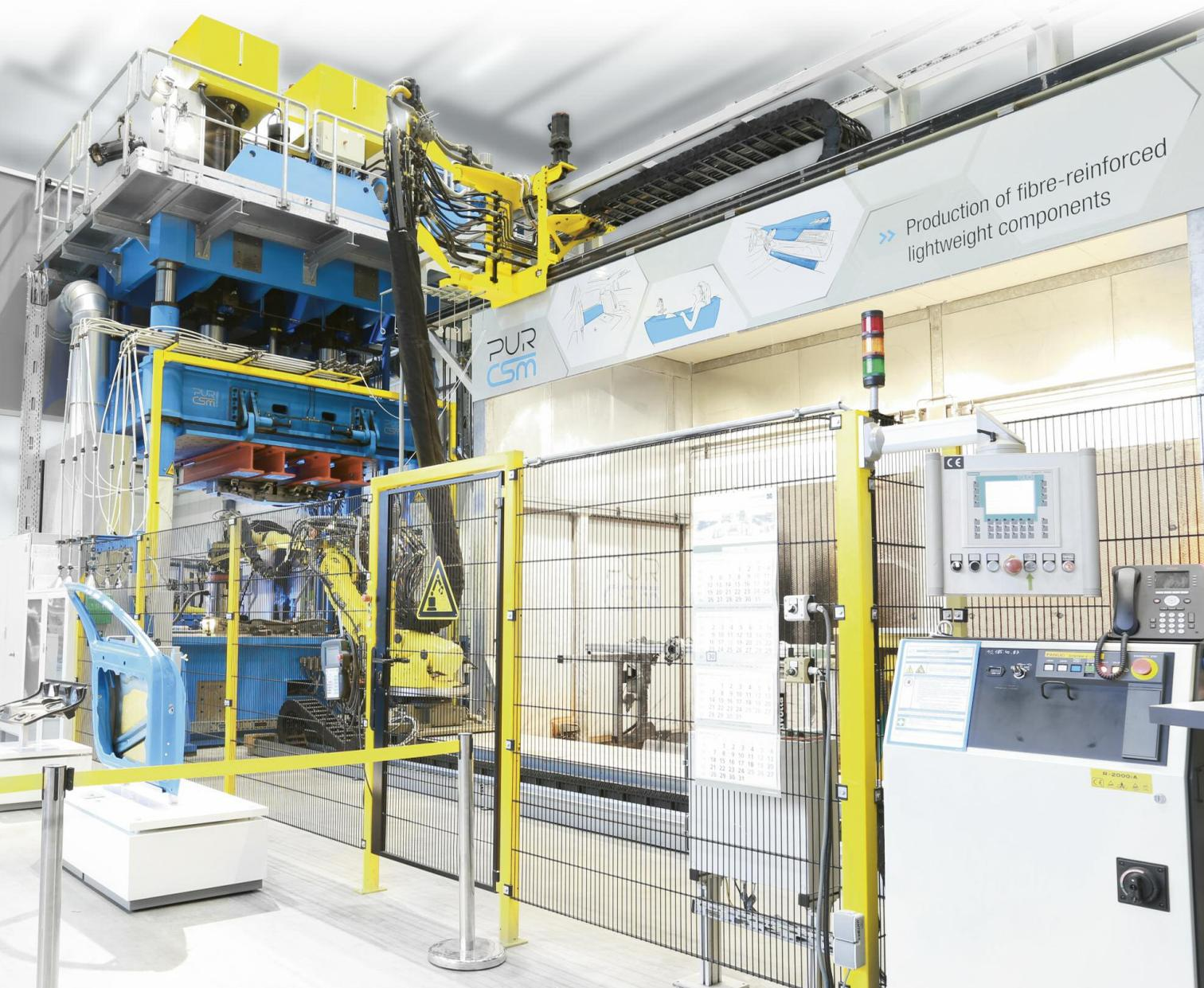
PUR-CSM-CENTER für alle Verfahrensvarianten der fortschrittlichen PUR-CSM-Sprühtechnik
