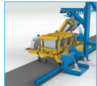
Mechanischer Schließvorgang und gezieltes Neigen aus- gewählter Formträger-Wagen
