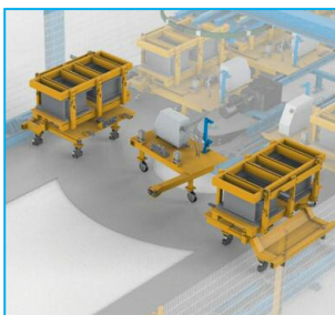
Automatische Ein- und Aus- schleusestation für Form- träger-Wagen (ECD)
